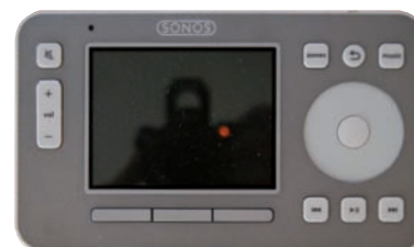
Il controller Sonos permette la gestione dell'impianto audio in multiroom per la riproduzione dei contenuti musicali
